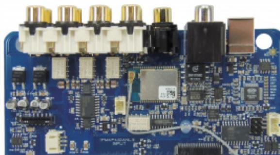
La conversion numérique analogique est assurée par une puce Sabre Premier ES9023P du fabricant américain ESS qui utilise la technologie exclusive Hyperstream permettant, selon ESS, d'éliminer le jitter. On ne trouve pas de filtres actifs à amplificateurs opérationnels après les sorties de ce convertisseur.
