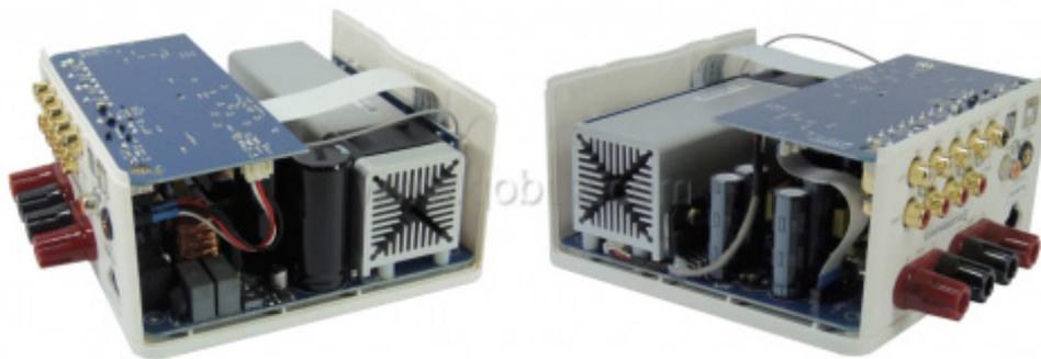
C'est un circuit Tenor TE7022L (24 bits à 96 kHz asynchrone) qui prend en charge les signaux en provenance de l'entrée USB B et c'est un transceiver (émetteur récepteur) Wolfson WM8804 qui interface les entrées S/PDIF coaxiale et optique.
