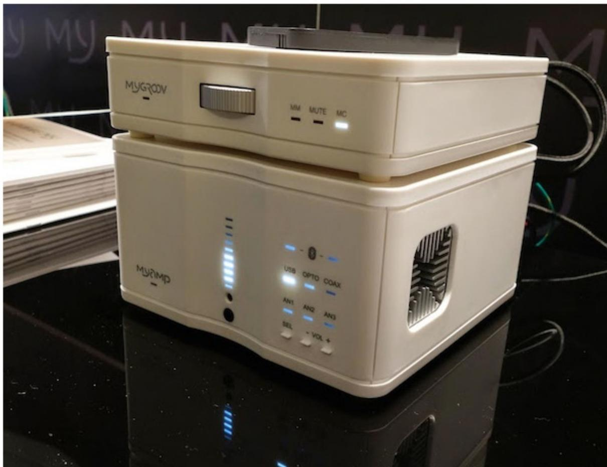
Micromega présentait son minuscule amplificateur MyAmp. Une petite merveille de technologie délivrant 2 x 30 watts sous 8 ohms et 2 x 60 watts sous 4 ohms. Il a la particularité d'intégrer un tunnel de refroidissement avec ventilateur hyper silencieux (seulement 12 dB) et un système d'alimentation "à résonance". Il possède plusieurs entrées analogiques et numériques (dont un port USB Audio), ainsi qu'une liaison Bluetooth AptX.
