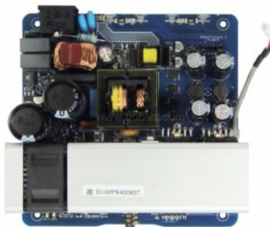
Les tensions secondaires sont redressées par des diodes Vishay SB5H100 supportant un courant de 5A et une tension inverse de 100V puis sont filtrées par quatre condensateurs de 2200  $\mu$ F/35V.
