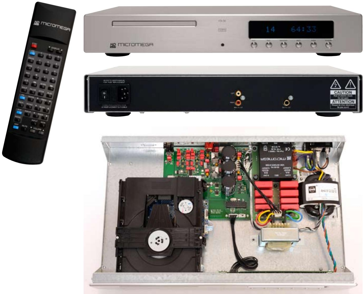
方研發的供電系統，名為 ACTS，系統會把數碼處理和模擬輸出分開供電，這隻 R-Core 是專為數碼模組供電並延伸出一組獨立線圈來為顯示屏供電，而模擬處理則由真空密封的 EI 型隔離變壓器負責，電源在輸送的過程裡會加入濾波處理，令輸出的音效能獲得更強的線性表現。廠方之所以用 R-Core 而不使用環牛是有其原因的，那是因為考慮到不是每位發燒友也有做電源處理，更多的情況是 DVD 機、薄屏電視機和 CD 機的電源插頭統統插在同一個排蘇上，電源如此的混亂，器材之間肯定會互相產生干擾，而環牛的電氣特性是比 R-Core 擁有較闊的頻寬，所以這些高頻干擾很容易經變壓器滲入機內，相反頻寬較窄的 R-Core 就沒有這種煩惱，工程師就是利用 R-Core 的電氣特性來減少干擾，以增強音色的純度和通透度。
