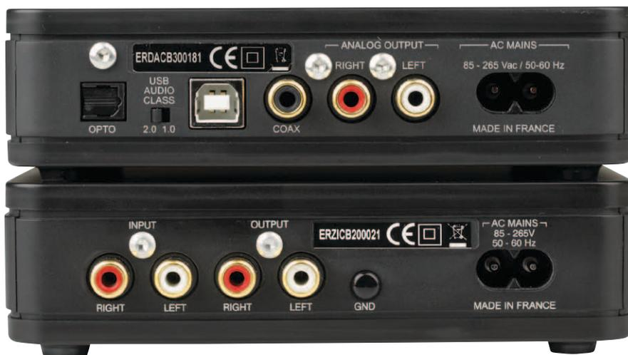
Der MyZIC schleift das Eingangssignal durch, um einfach in eine bestehende Anlage integriert werden zu können
