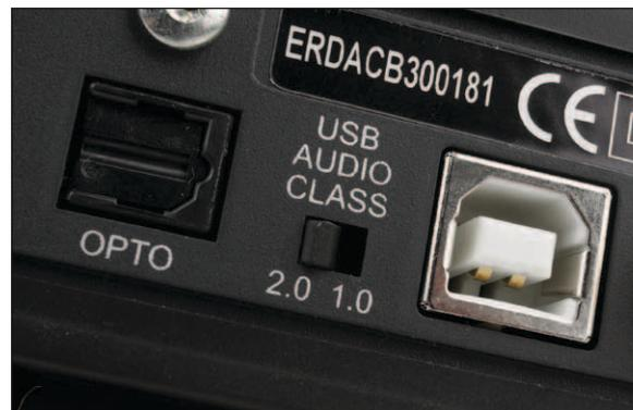
Mit dem kleinen Schalter kann der MyDAC auf USB 1.0 geschaltet werden, falls man keine Treiber installieren will und 96 kHz maximale Samplingrate genug sind
