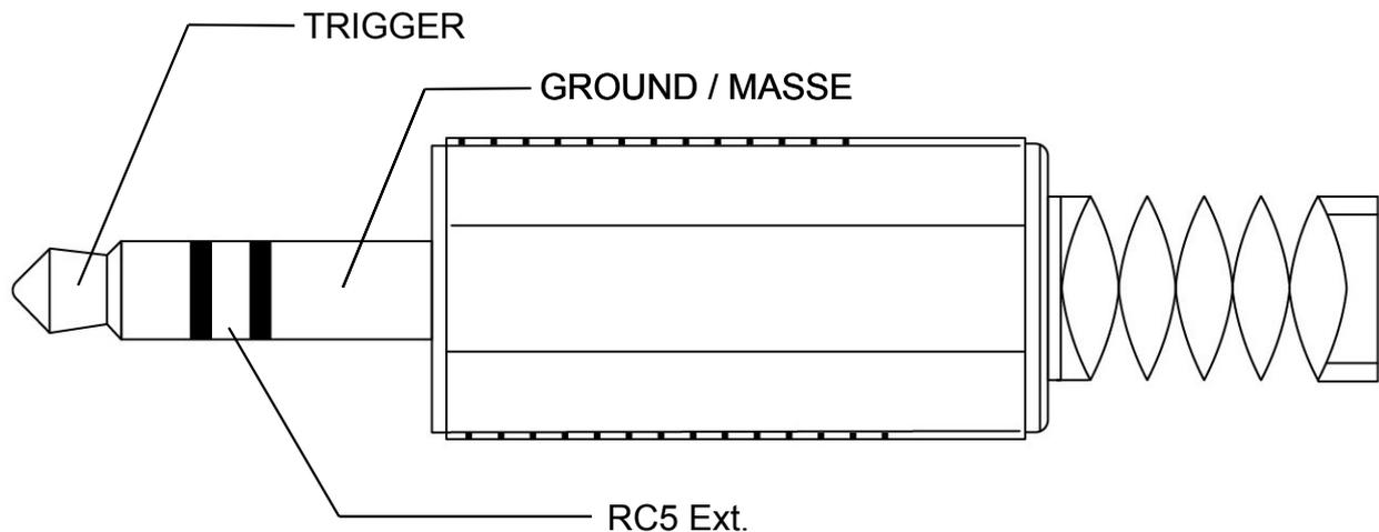
MyAMP est pourvu sur la face arrière d'un connecteur Jack  $\varnothing$  2.5mm au dessus duquel se trouvent les indications suivantes : TRIG / IR-IN. En vous référant au diagramme ci-dessus vous pouvez soit mettre MyAMP en ou hors veille en envoyant entre la borne MASSE et l'entrée TRIGGER une tension continue positive dont la valeur doit être comprise entre 5V et 12V.
